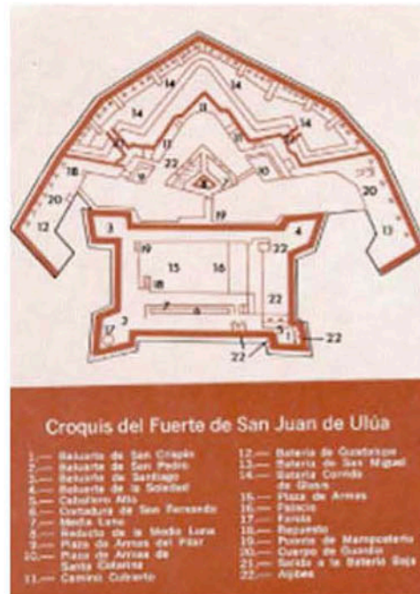
Croquis que muestra los baluartes donde se encontraban las baterías de artillería
