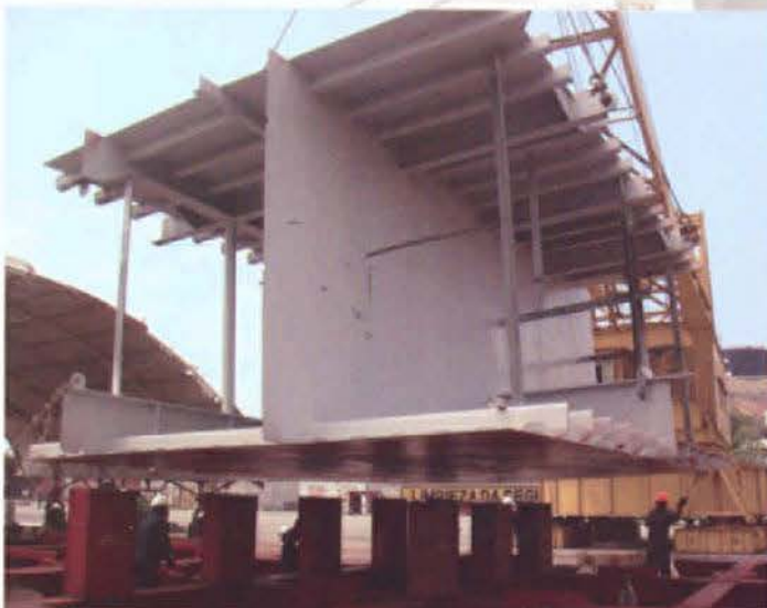
Al primer bloque colocado en la cama de erección se le considera la puesta de quilla.
