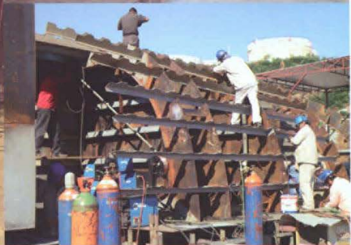
Luego de cortadas las piezas se conforman los bloques y módulos.
