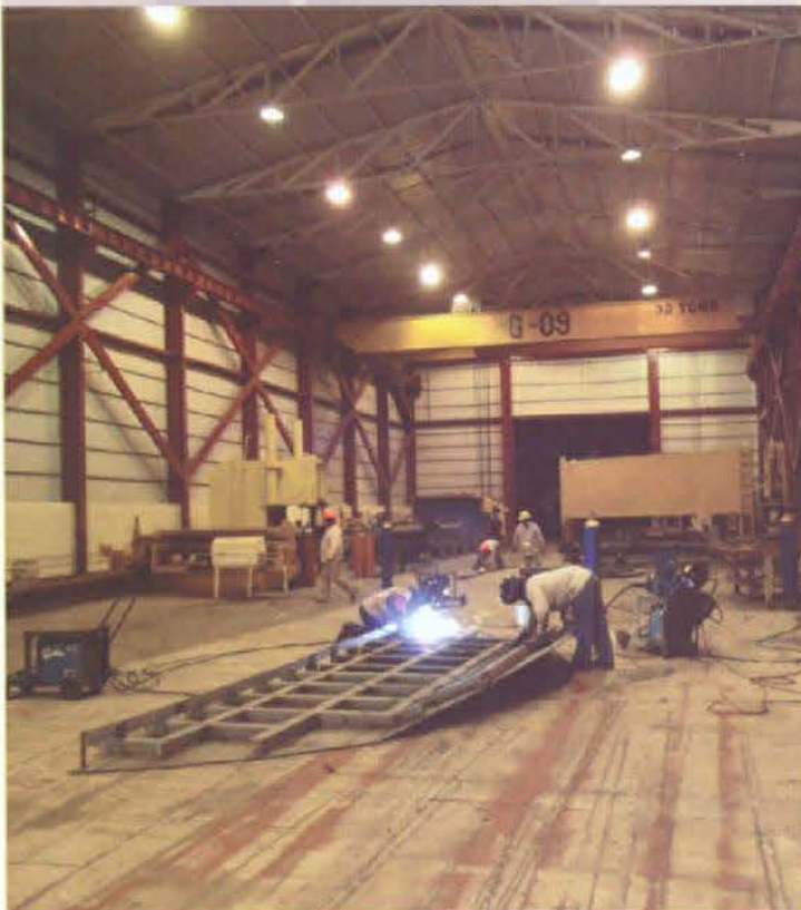
Luego de cortadas las piezas se conforman los bloques y módulos.
