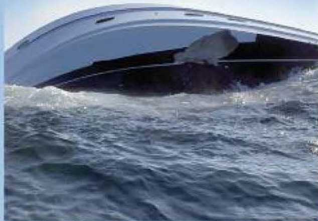
Rasgadura en el casco que provocó la vía de agua.
