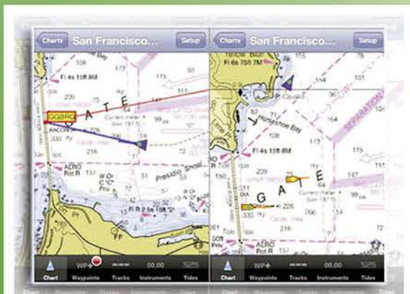
Carta RASTER desplegada en un navegador. La posición del buque es recibida del GPS y representada sobre la carta.
