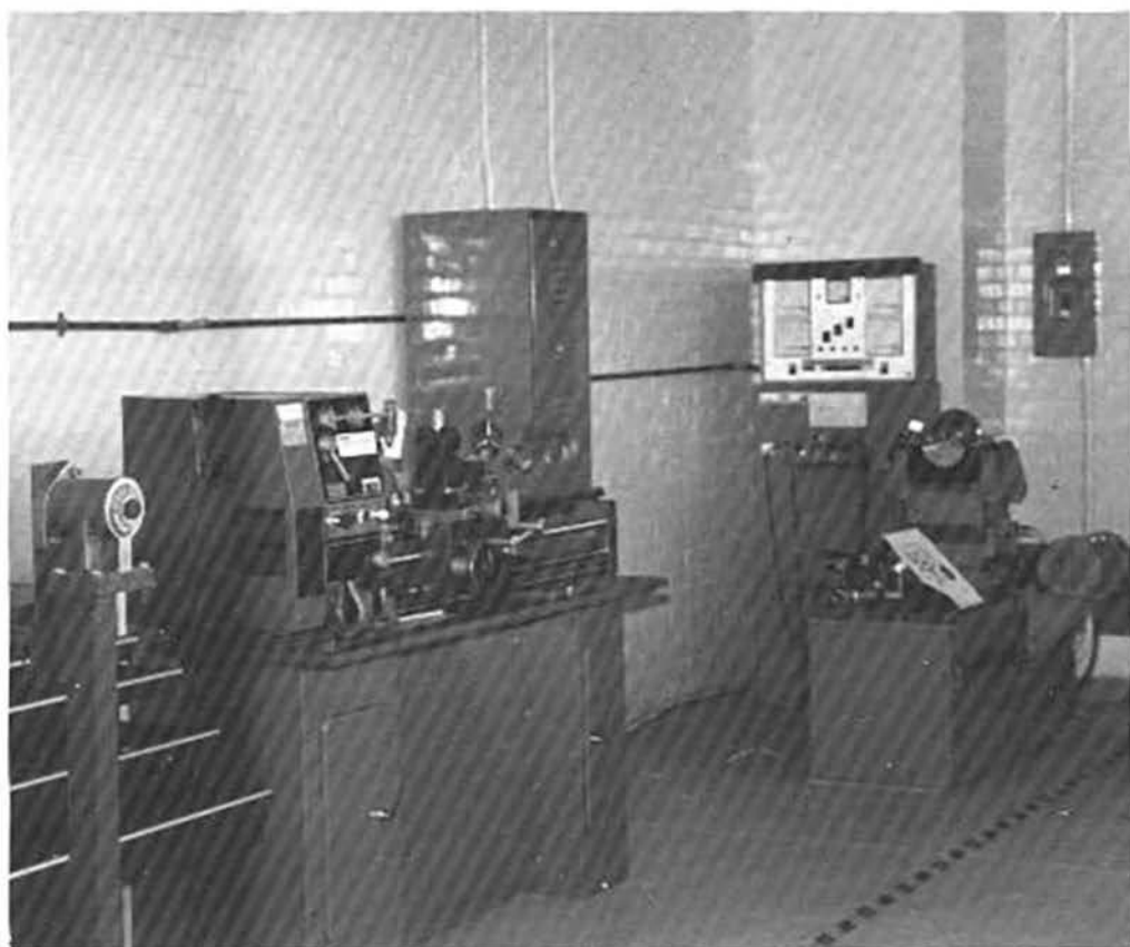
También se cuenta con un torno para la elaboración de algunas de las piezas de las turbinas.
