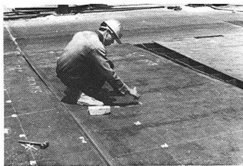
*Una vez que se definieron las formas del casco, la cartilla correspondiente se remitió a la sala de galibos de los astilleros para efectuar el trazo y afinación sobre placas de acero (etapa 05, delineación del casco).*
