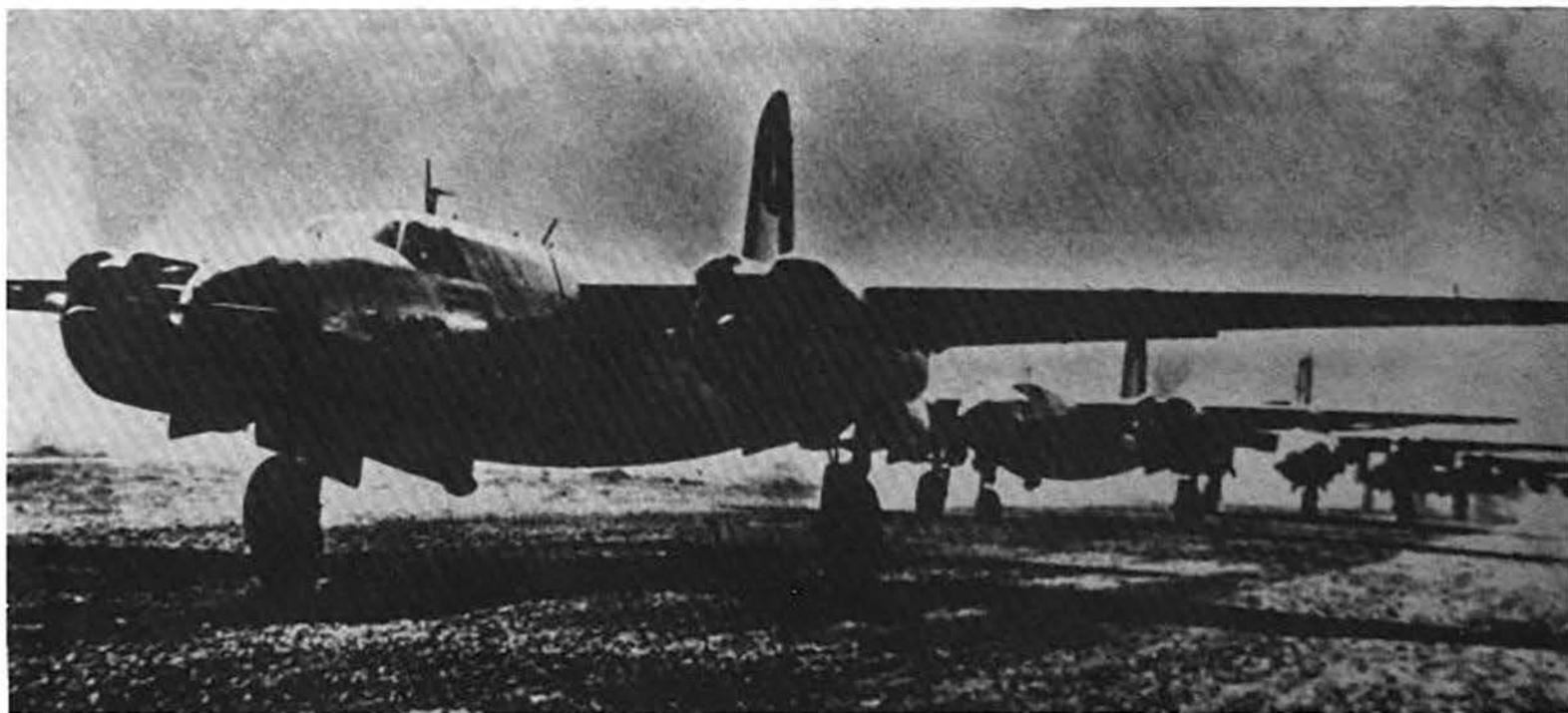
Los bombarderos B-26 *Marauder* transportaban 1,800 kilogramos de bombas y estaban armados con 11 ametralladoras. Viajaban a 450 km/h, alcanzaban un techo de 5 mil metros y eran tripulados por seis o siete hombres.
