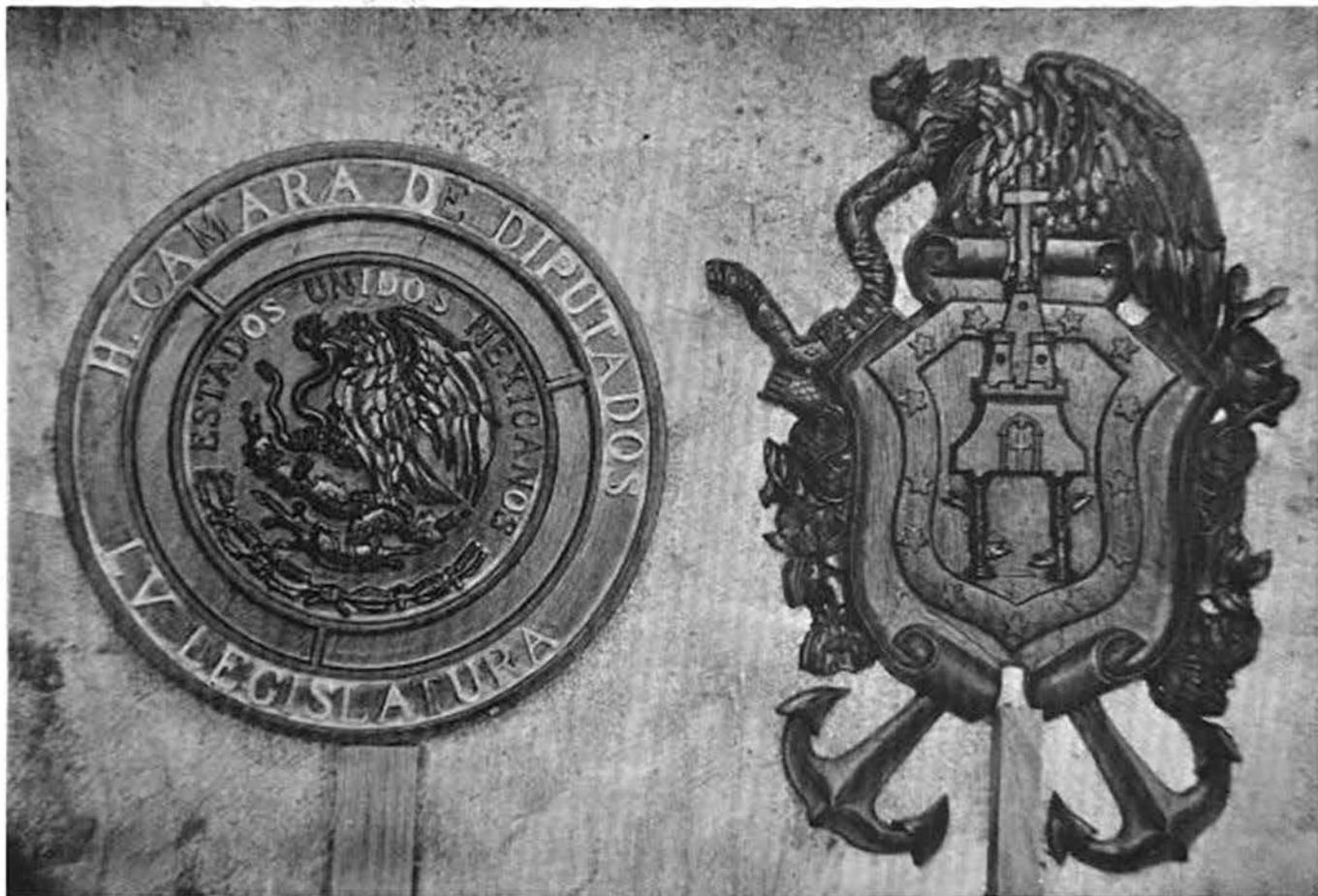
La elaboración de piezas especiales de madera para la fundición en bronce, latón, aluminio o plomo, se lleva a cabo en el Taller de Modelos.
