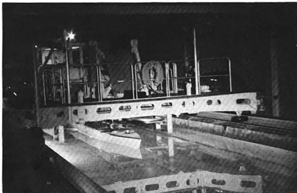
*El prototipo del Holzinger durante las pruebas en el canal hidrodinámico.*
