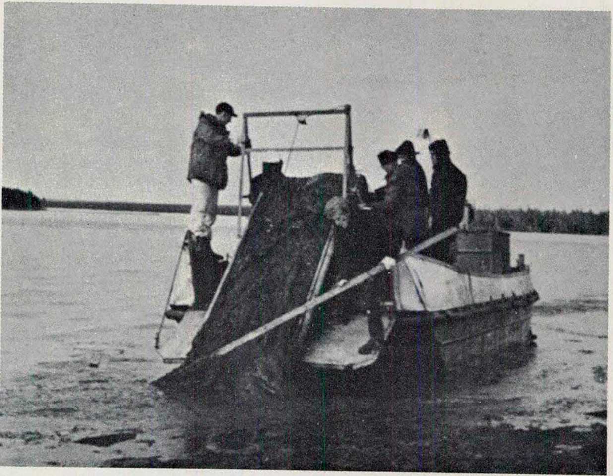
Figs. 10 y 11. Bote extractor de hidrocarburos recogiendo petróleo del «Arrow».
