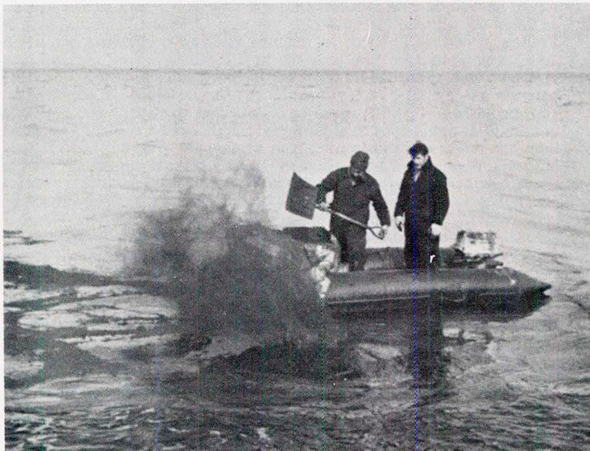
Fig. 4. Espolvoreando turba granulada sobre una mancha de petróleo.
