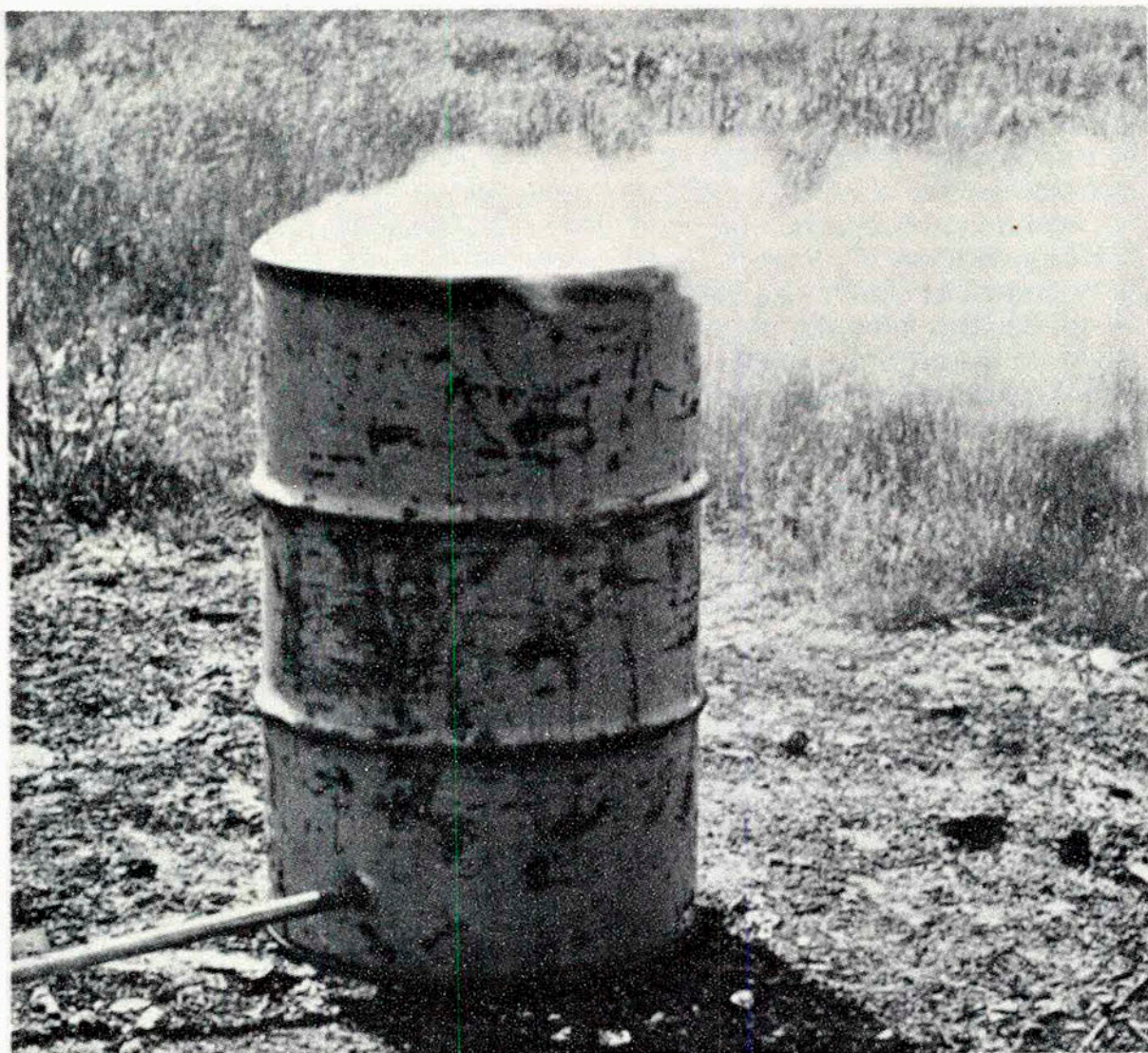
Fig. 18. Bidón de petróleo vacío usado para quemar grumos y restos petrolíferos en la playa. Se ha suprimido una de las tapas e instalado un tubo para inyectar aire en la parte baja.
