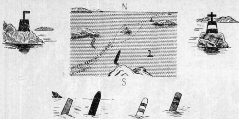
Fig. 1 c. Balizamiento de las aguas noruegas (señalamiento de una ruta de navegación). A izquierda y derecha, dos marcas fijas; en la parte inferior, señales flotantes. Traducción del texto noruego del grabado del centro: "Dirección de la ruta Sur-norte, (ruta principal)".
