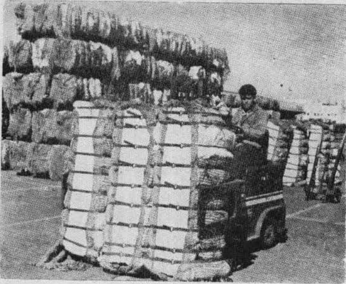
4. Carro estibador, trabajando como elemento transportador de una unidad de carga constituida por tres pacas. La carga que se ve al fondo se encuentra "paletizada". (Puerto de Long Beach).
