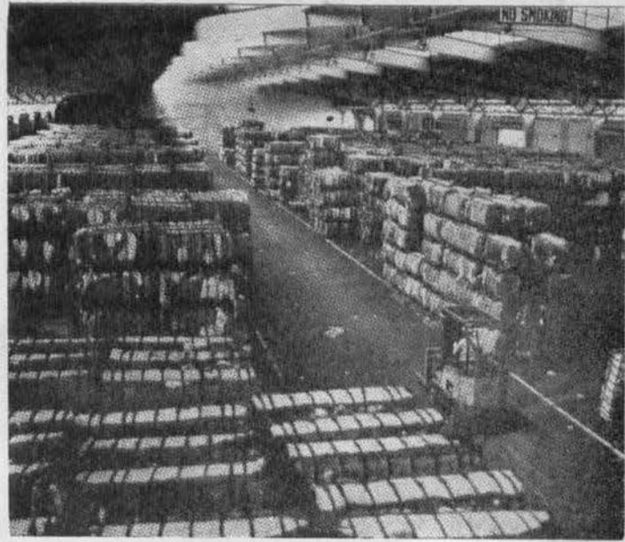
2. Vista parcial de una bodega de tránsito ocupada por pacas de algodón. Obsérvese la altura de su almacenamiento, cinco pacas, que atiende al reglamento de fuego de la Ciudad. El elemento transportador que circula es un carro estibador de horquillas. La carga se encuentra "paletizada" con el objeto de facilitar la entrada de las horquillas. Obsérvese el gran espacio de circulación. (Puerto de Long Beach).
