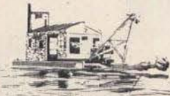
Ellicott "DRAGON" 10 Puede armarse fácilmente en 4 días. Bombea lodo, sedimento, arena y grava por tubos de descarga hasta de 760 metros de largo. Capacidad de 60 a 230 metros cúbicos por hora.
