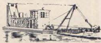
Ellicott "DRAGON" 12 Excava 75 a 300 metros cúbicos por hora de lodo, sedimento, arena y arcilla, y bombea por tubos de descarga hasta de 1220 metros de largo. Puede trabajar en un canal de ancho mínimo de 15 metros.
