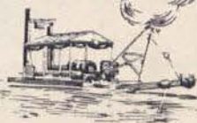
Ellicott "DRAGON" 8 Capacidad de 37 a 115 metros cúbicos por hora a través de tubos de descarga hasta de 610 metros de largo. Pueden obtenerse con caseta cerrada o con plataforma tropical, como se ve en el grabado.
