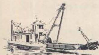
Ellicott "DRAGON" 20 "DRAGON GIGANTE"—se arma en unas pocas semanas. Puede bombear 300 a 950 metros cúbicos por hora a través de tubos de descarga hasta de 1800 metros de largo. Motor Diesel-eléctrico.
