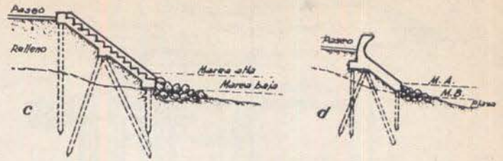
Fig. 21.—Muros de defensa en talud.
