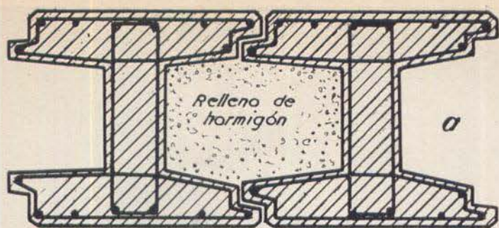
Sección de las tablestacas hincadas en el recinto de la Escuela Náutica de Veracruz.
