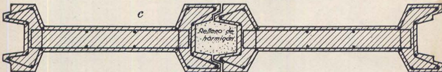
Fig. 24.—Secciones de tablestacas de hormigón armado.
