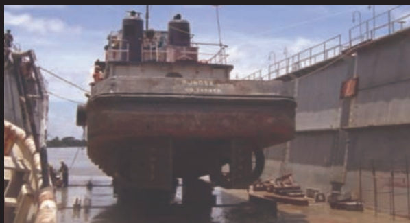
Puesta en seco del buque particular Pomosa V en las secciones del dique flotante, agosto 2007.
