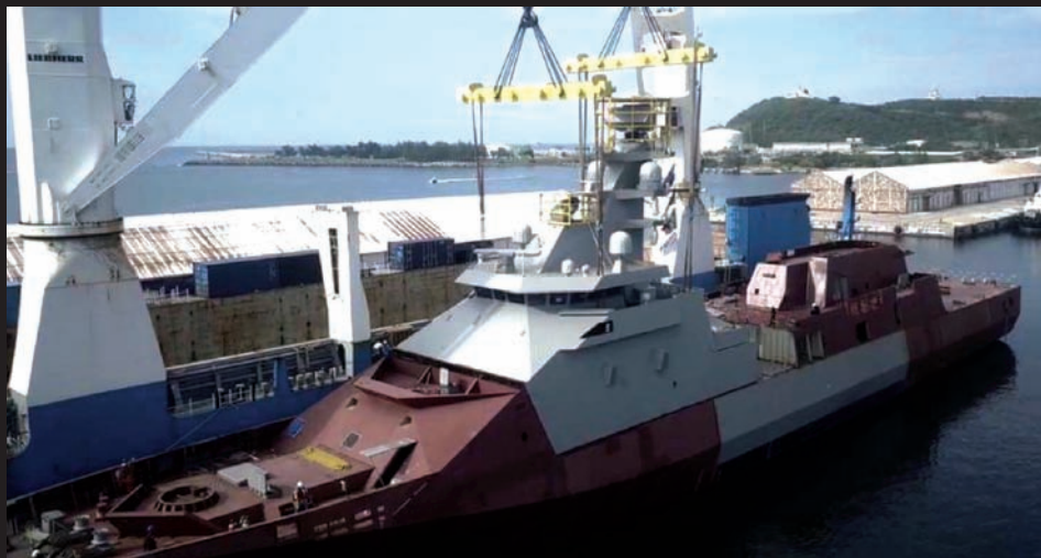
Construcción de dos módulos de la POLA de México en el puerto holandés de Vlissingen.
