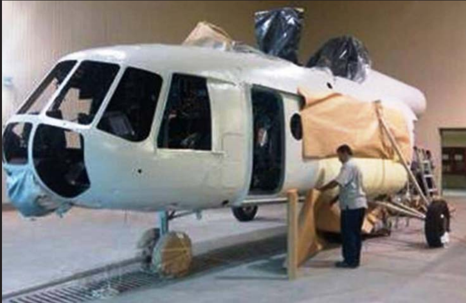
Ensamblado del helicóptero MI-17 ANX-2221 después de efectuarle una reparación mayor.
