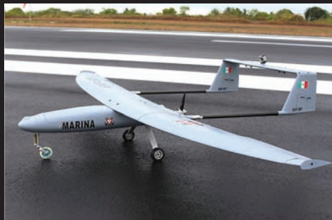
El Spartaam, con capacidad de transmitir imagen y video en tiempo real, dos horas de autonomía, alcance máximo de 50 millas náuticas, altitud operacional de 13,000 pies, envergadura de 4.80 metros y una longitud de 2.70 metros.
