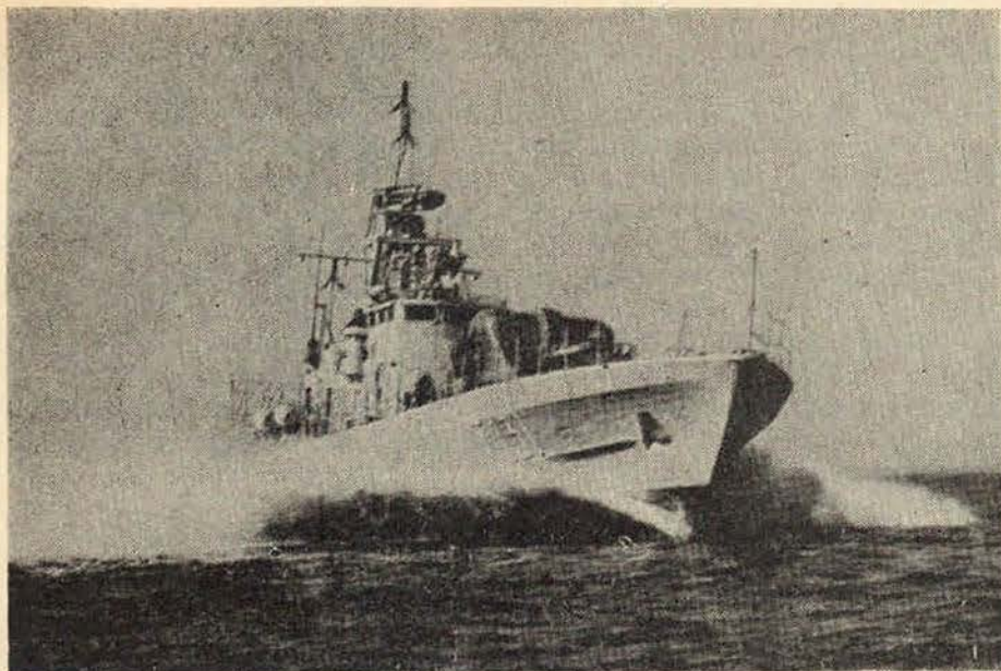
Lancha patrullera sueca Spica II provista de tres turbinas Rolls-Royce de 4,500 caballos, para una velocidad de 40 nudos.
