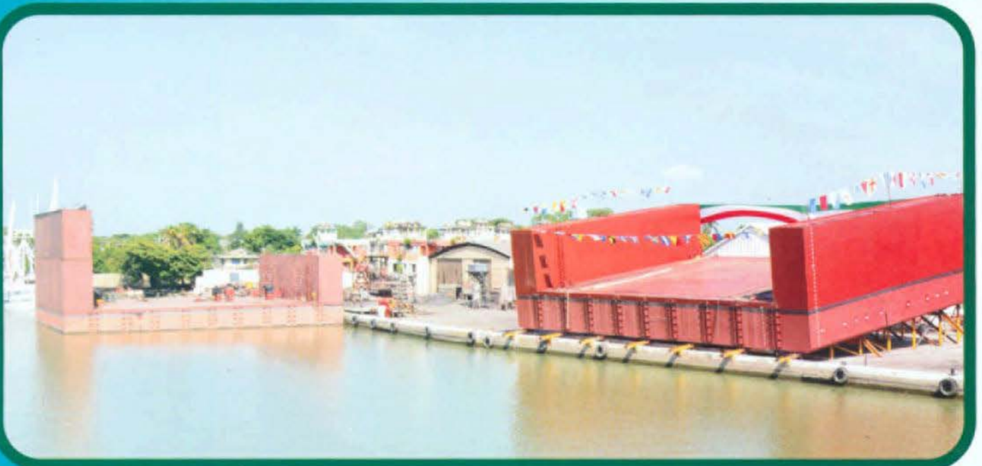
La Segunda Sección de Dique fue lanzada de costado desde una rampa creada para este fin.
