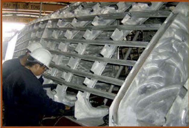
El armado de las embarcaciones se realizó con el método de producción denominado módulos invertidos...
