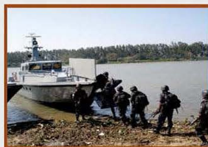
Por su poco calado son capaces de navegar en aguas restringidas y desembarcar personal a tierra por medio de su rampa en proa.
