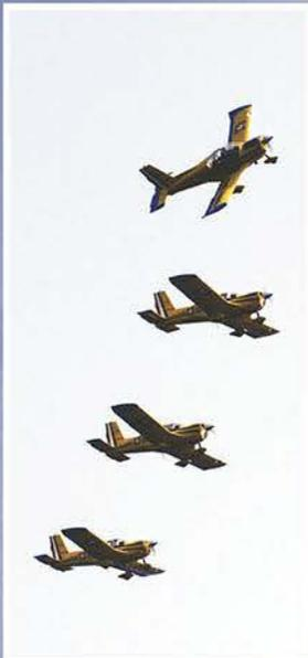
En tanto, los **Lancair Super ES** son aeronaves de ala baja, monomotores, de tren fijo, desarrollan una velocidad de 180 nudos con un techo de servicio de 18,000 pies, autonomía de 4.5 horas y capacidad para cuatro tripulantes. Cabe hacer mención que estas aeronaves fueron fabricadas y armadas, parcialmente, en la base aeronaval de Veracruz por personal de esta institución.
