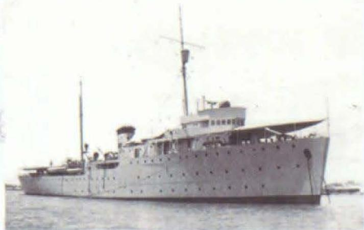
La nomenclatura de sus compartimientos se rigió por las normas establecidas antes de 1949. Su construcción original fue a base de remaches; debido a los conceptos modernos en la construcción de buques, este aspecto fue cambiado y actualmente cuenta con una construcción mixta, ya que en las diversas reparaciones de que ha sido objeto, las planchas de acero que le cambiaron fueron soldadas y no remachadas como las originales.
