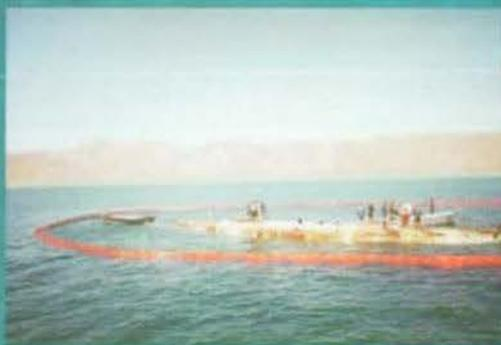
Tal situación provocó que el buque atunero se hundiera por su banda de babor, a una profundidad de 10 m aproximadamente, en las coordenadas geográficas de 25°59'24" latitud norte y 111°06'22" longitud oeste, en la bajamar, el casco queda al descubierto provocando su erosión y corrosión.
