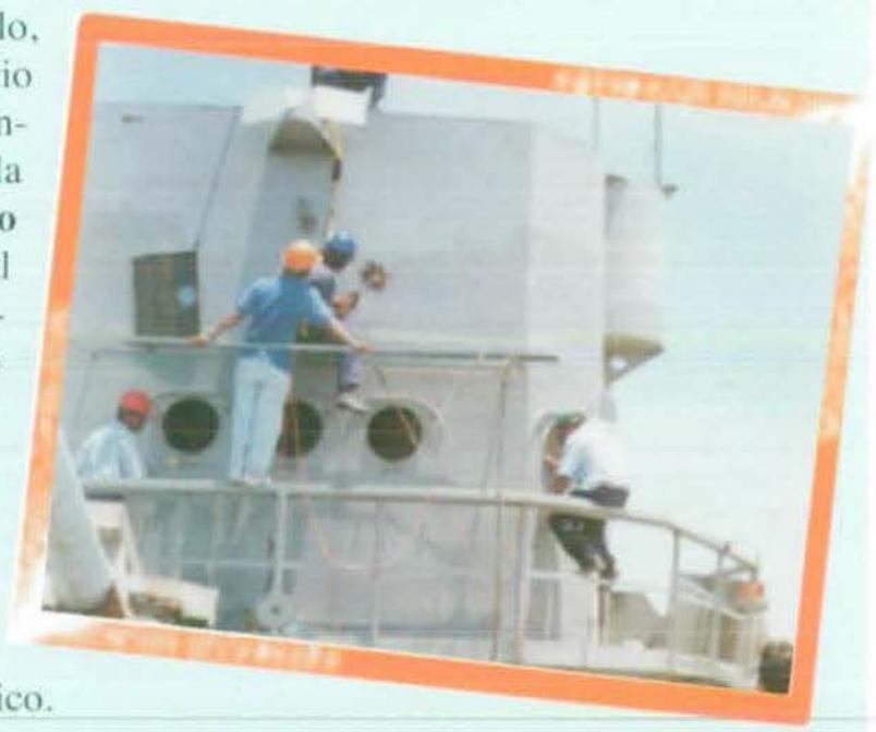
Para efectuar los cortes de las planchas metálicas se uso equipo de oxiacetileno, iniciando con los cortes mayores sobre cubierta y costado. El material que se encontraba en el interior del barco se extrajo a través de las lumbreras hechas sobre la cubierta y por las escalas de acceso al cuarto de máquinas.
