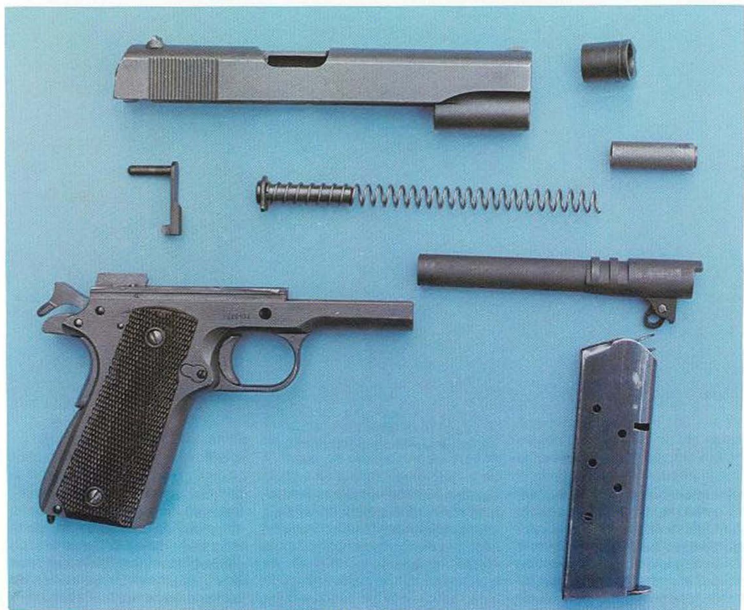
Para su estudio la pistola Cal. 45 c.d.p. se divide en cuatro grupos: a) de la empuñadura; b) del cañón; c) del carro y d) del cargador.
