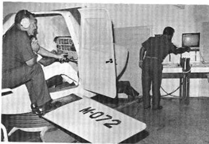
Salón de instrucción de vuelo por instrumentos con sus respectivas unidades de monitoreo y control; en ellos se capacita a los pilotos en vuelo guiado únicamente por instrumentos, sin referencia visual del terreno.
