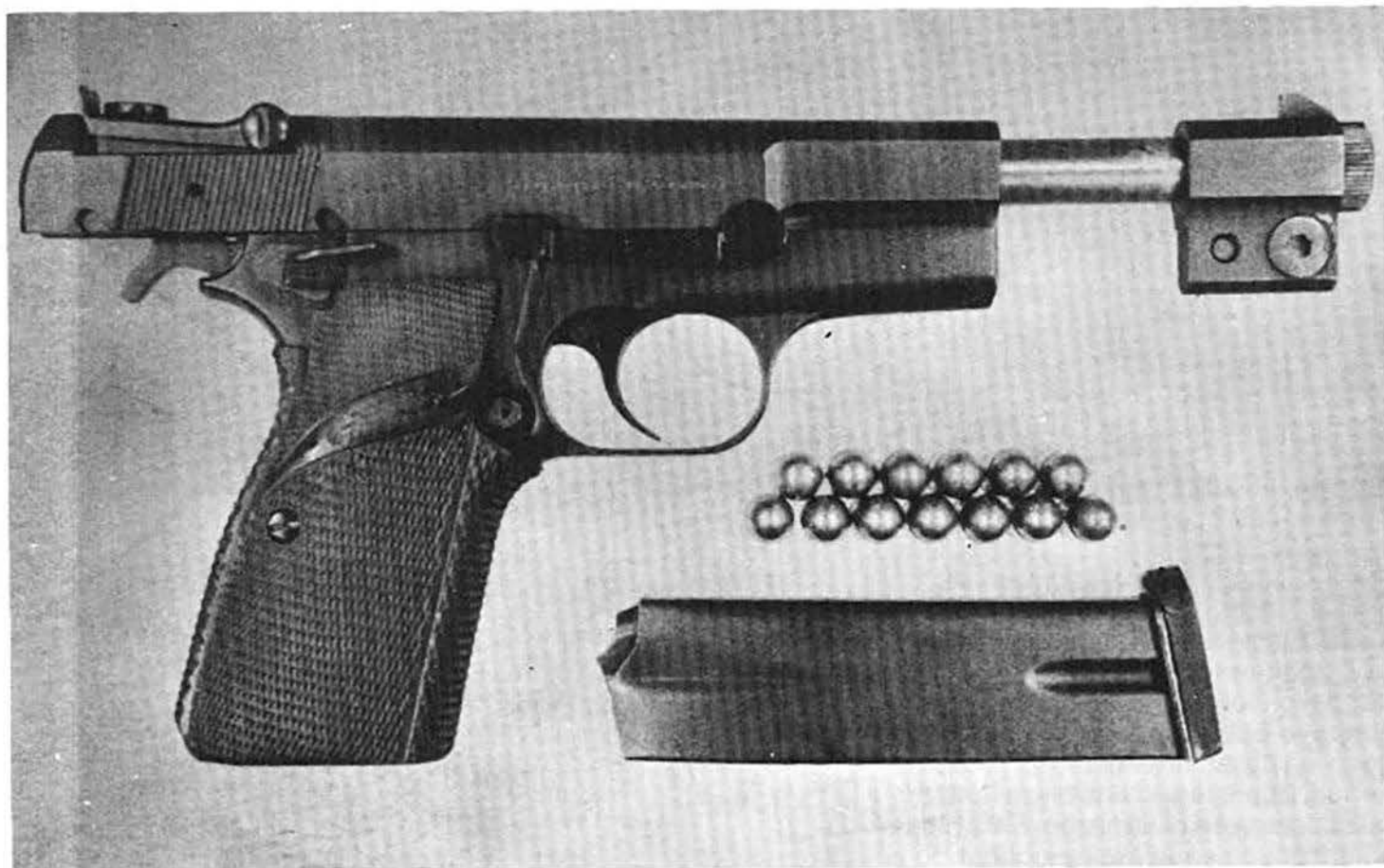
Pistola FN deportiva con cañón de 6 pulgadas y contrapeso. Aspecto con la corredera abierta.
