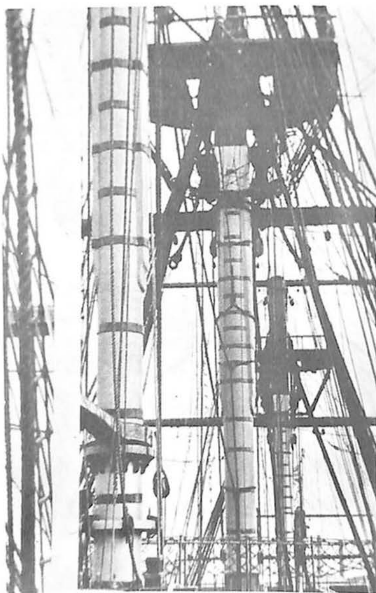
Vista hacia la proa de toldilla, que muestra los cientos de metros de cordaje y algunos de los casi 150 motones requeridos para un primera clase.
