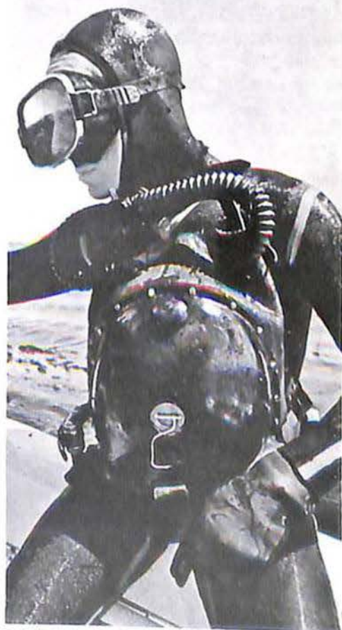
El sistema de respiración de circuito cerrado recicla el oxígeno exhalado y fija el anhídrido carbónico residual por medios químicos para que el gas pueda ser respirable en el interior de la escatandra.
