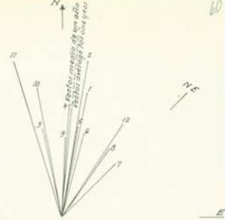
VECTORES DEL ACARREO LITORAL CALCULADOS DE LAS OBSERVACIONES DEL VIENTO 1948 LITTORAL DRIFT VECTORS CALCULATED FROM WIND OBSERVATIONS 1948.
