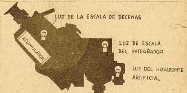
FIG. 7 - ESQUEMA DE UBICACION DEL ACUMULADOR Y LUCES
