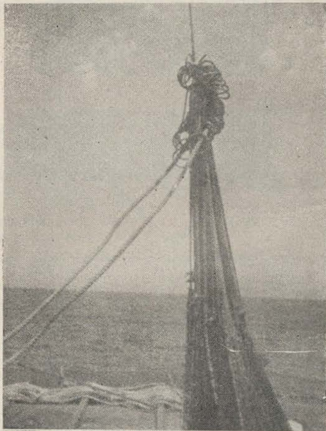
Foto 2.—Los anillos estrobados son izados por la pluma.
