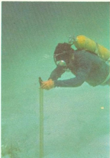
Obtención de un núcleo de sedimentos submarinos por método directo
